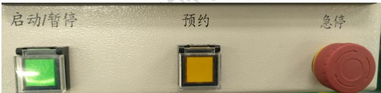
启动：这是程序的启动按钮，在回零完毕的状态下，按下该按钮，绕线机就开始动作。
