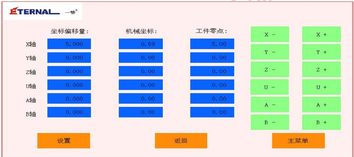
其中坐标偏移量可点击输入坐标，点击 **设置** 即可把坐标设置为工件零点。机械坐标显示的是当前各轴的坐标，工件零点显示当前的工件零点坐标。此外还可手动各轴使之移动到适合的位置设定为工件零点。
